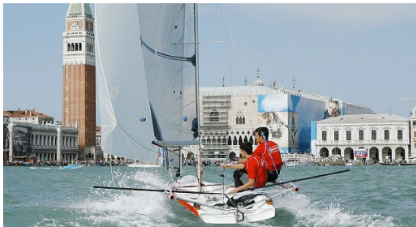
Galileo Innovaction: Aretè presenta una barca a vela con uno scafo composto per oltre il 70% di fibre naturali.
